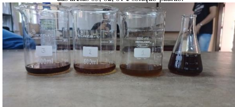
Figura 5 – Soluções obtidas no ensaio de impurezas orgânica, onde, da esquerda para a direita, estão as soluções das areias 03, 02, 01 e solução-padrão.
