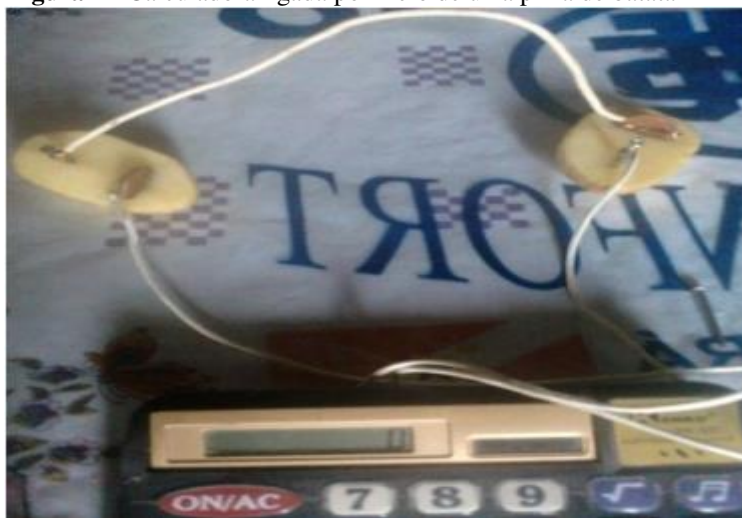
Figura 4 - Calculadora ligada por meio de uma pilha de batata
