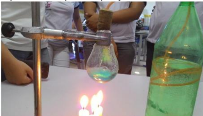
Figura 10 - Destilação da solução aquosa de sulfato de cobre
