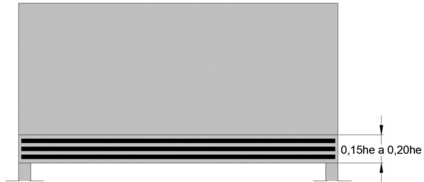
Figura 2.4.1.1 – Distribuição da armadura do banzo tracionado.
