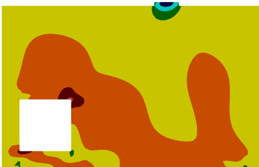
Figura 6.4.5 – Campos de tensões em viga-parede com abertura pelo código implementado: a) tração e b) compressão.
