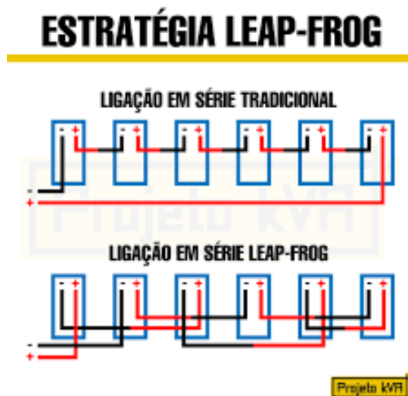
Figura 5 - ligação tradicional x Leap-Frog
