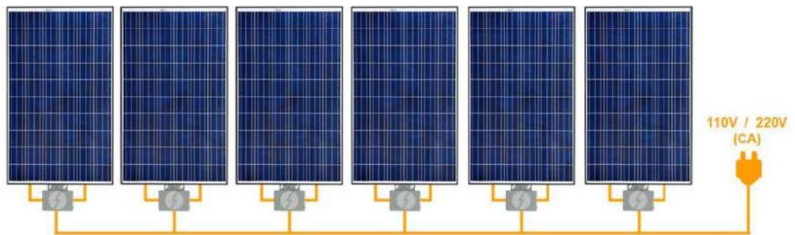
Figura 4 - Sistema fotovoltaico com microinversor
