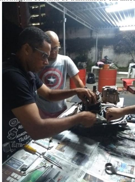
Figura 9 - Desmontagem de caixa de transmissão em ambiente controlado.
