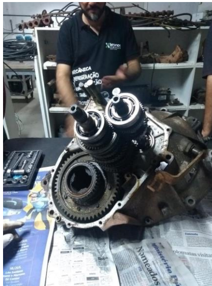
Figura 10 - Análise de falha em uma caixa de transmissão mecânica automotiva
