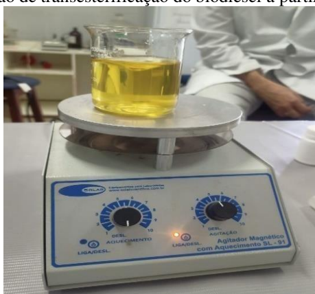
Figura 6 – Reação de transesterificação do biodiesel a partir do óleo residual.
