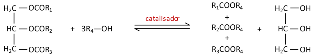
Figura 3 – Esquematização da reação de transesterificação.
