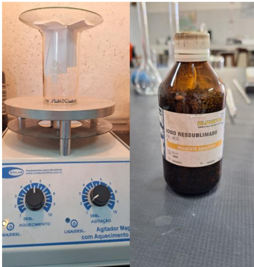
Figura 3 – Procedimento experimental de coleta de impressões digitais com o vapor de iodo.
