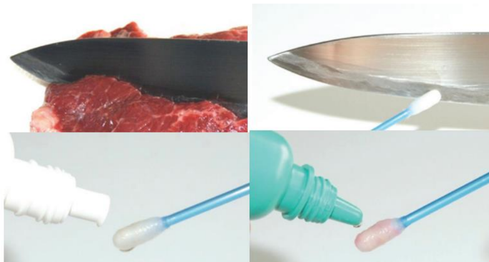
Figura 4 – Procedimento experimental de detecção de sangue utilizando o reagente de Kastle-Meyer.
