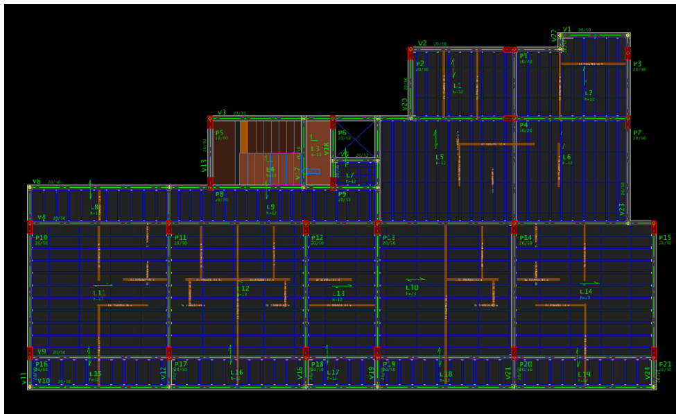
Figura 22 - Pavimento tipo com laje treliçada
