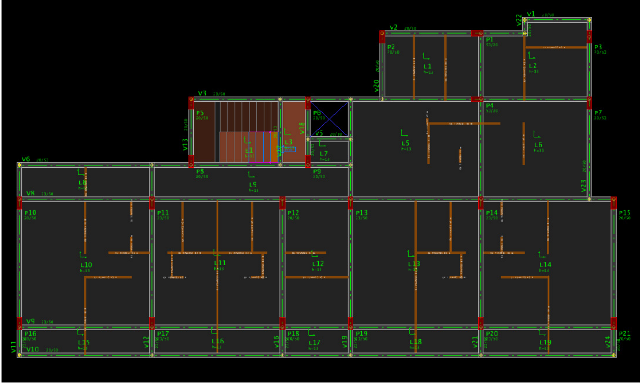
Figura 18 - Pavimento tipo com laje maciça
