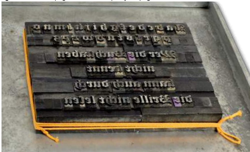
Figura 04. Navio tipográfico com composição tipográfica acabada e cordão de coluna.
