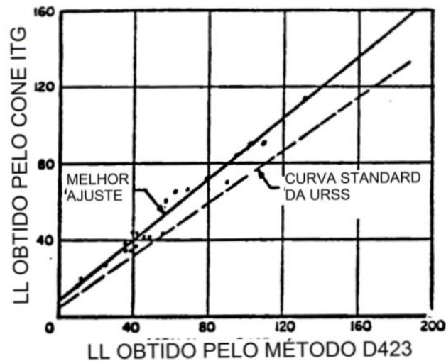
Figura 5. Limite de Liquidez obtido pelos métodos de Casagrande e do cone de penetração
