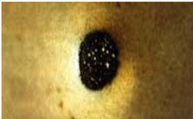
Figura 6 - Defeito de pintura "olho de peixe". Fonte: Axalta, s.d.
