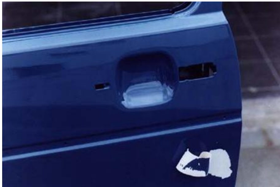
Figura 9 - Defeito de descascado na pintura. Fonte: Axalta, s.d.
