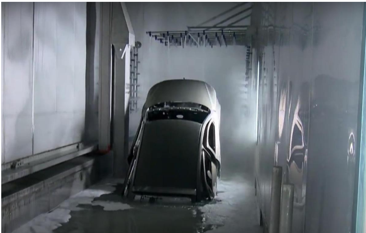
Figura 2 - Imagem da pintura por eletrodeposição da Volkswagen. Fonte: Coisas de agora (2012).
