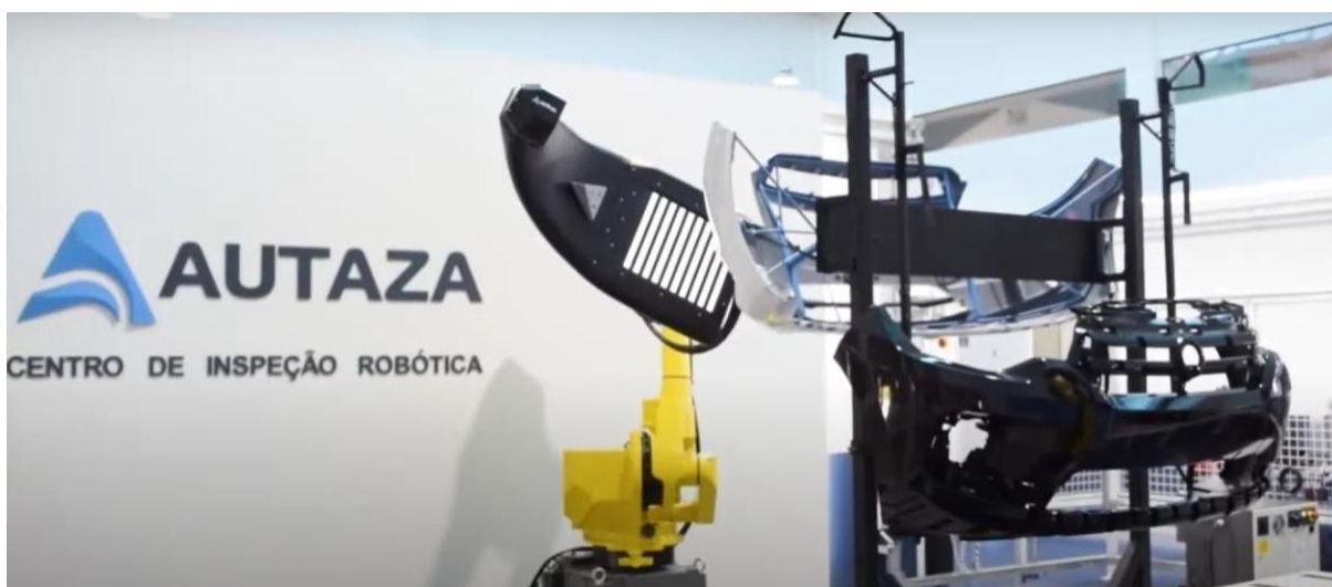
Figura 15 - Sistema automatizado para inspeção de qualidade na pintura automotiva. Fonte: Autaza, 2022.
