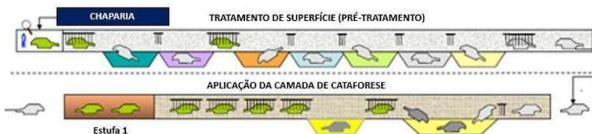
Figura 1 - fluxograma do processo de pré-tratamento e eletrodeposição, adaptado de DRUMOND, por SICHÍ (2021)
