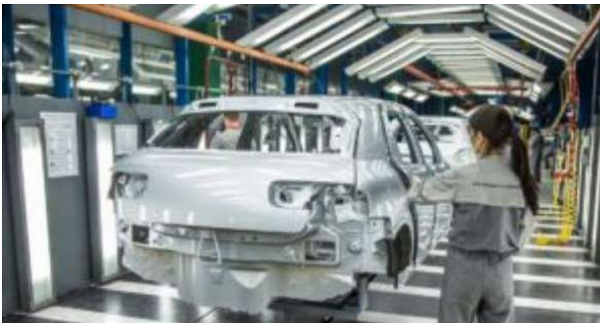
Figura 12 - Inspeção sendo realizada após pintura da carroceria. Fonte: SICHI (2021)
