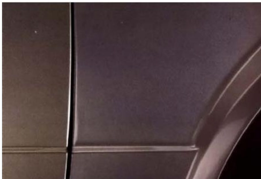
Figura 11 - Defeito de falta de brilho na pintura. Fonte: Axalta, s.d.
