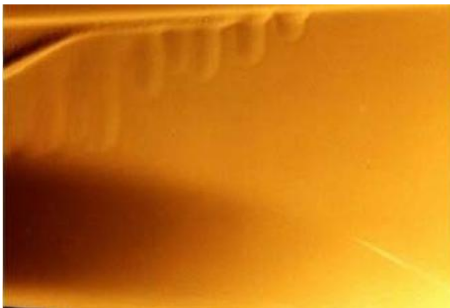
Figura 8 - Defeito de escorrido na pintura. Fonte: Axalta, s.d.
