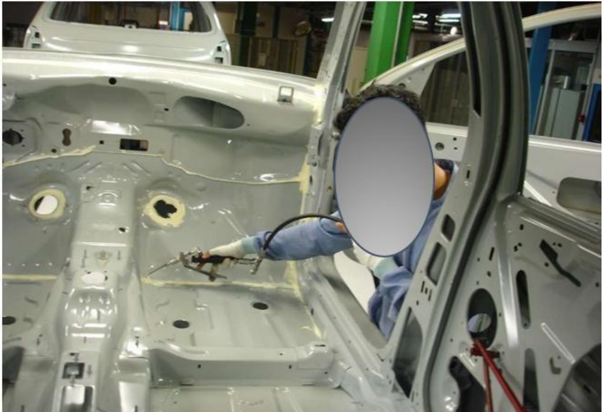
Figura 3 – vedação sendo aplicada de forma interna. Fonte: SICHI (2021)
