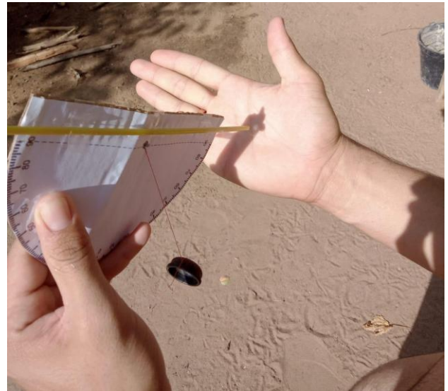
Figura 4 – utilização do astrolábio caseiro (a) utilização na sala de aula e (b) medindo a altura angular do sol
