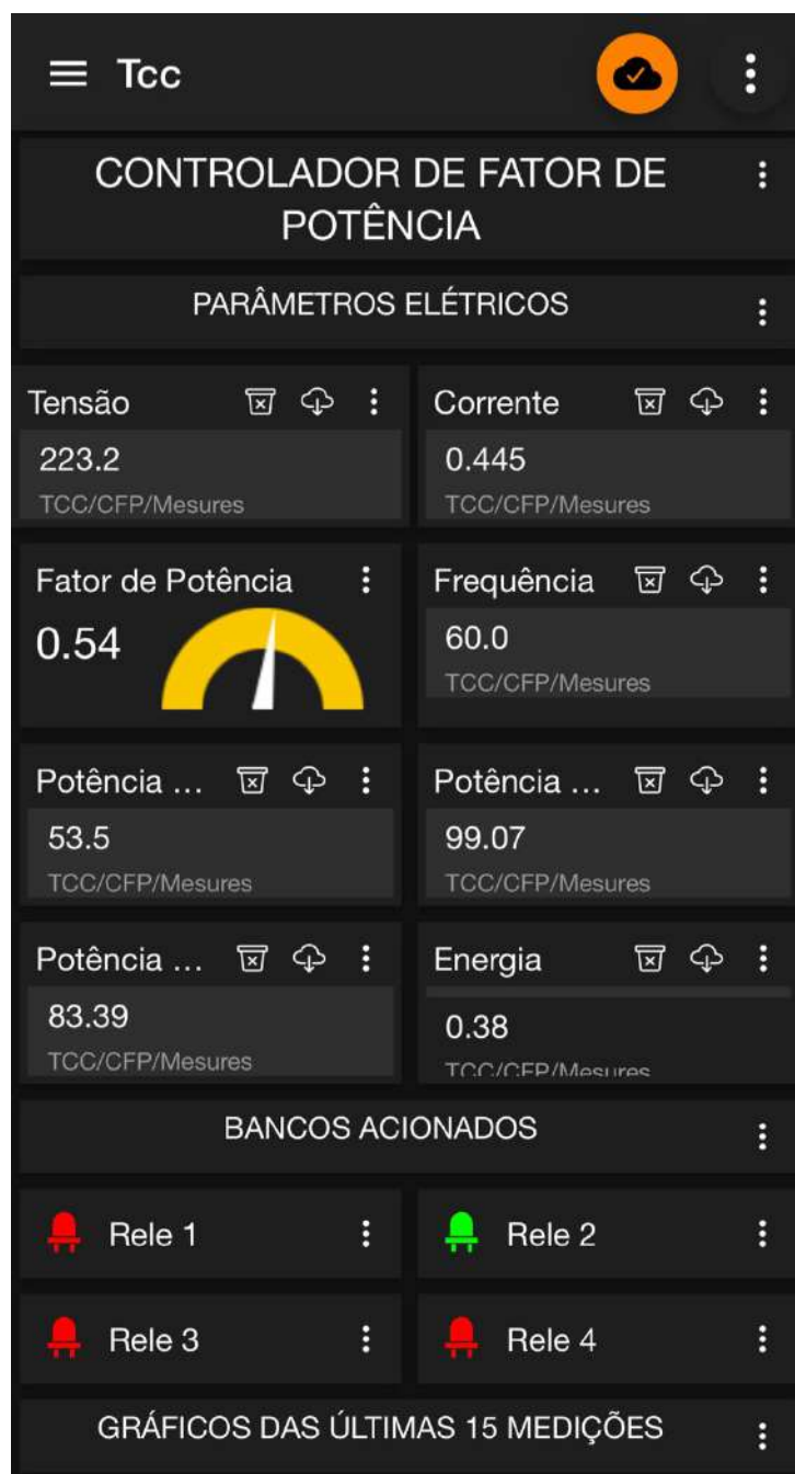
Figura 57 – Primeira medição dos parâmetros do dispositivo via MQTT
