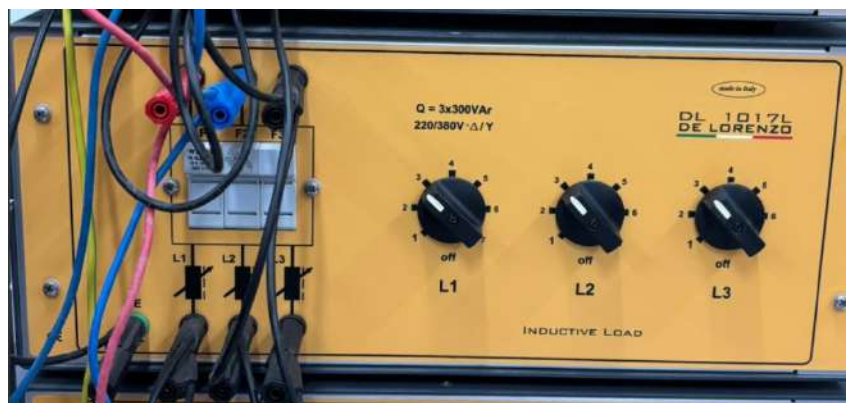
Figura 47 – Primeiro estágio da Carga indutiva configurada.
