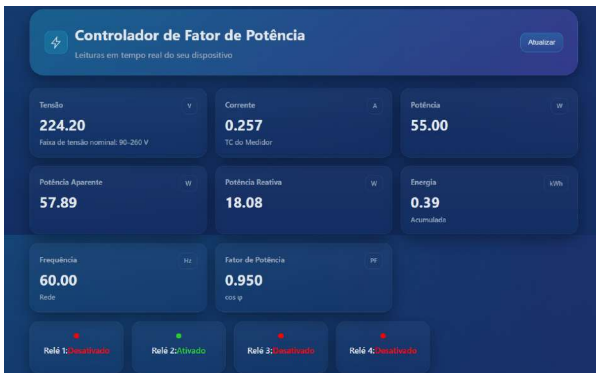
Figura 58 – Segunda medição dos parâmetros do dispositivo via WebServer
