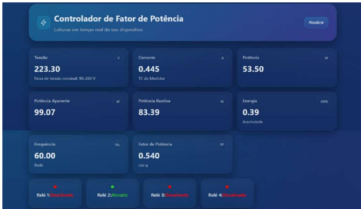
Figura 56 – Primeira medição dos parâmetros do dispositivo via WebServer
