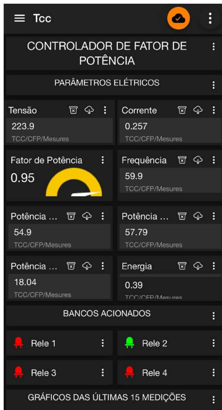
Figura 59 – Segunda medição dos parâmetros do dispositivo via MQTT
