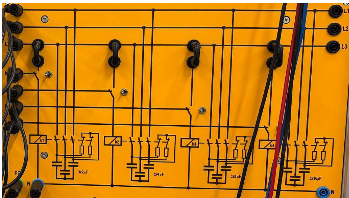
Figura 50 – Carga capacitiva configurada.
