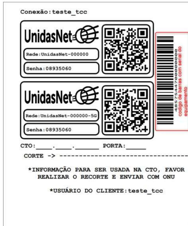
Figura 7 – Etiqueta contendo a imagem das informações de acesso a rede sem fio da ONU
