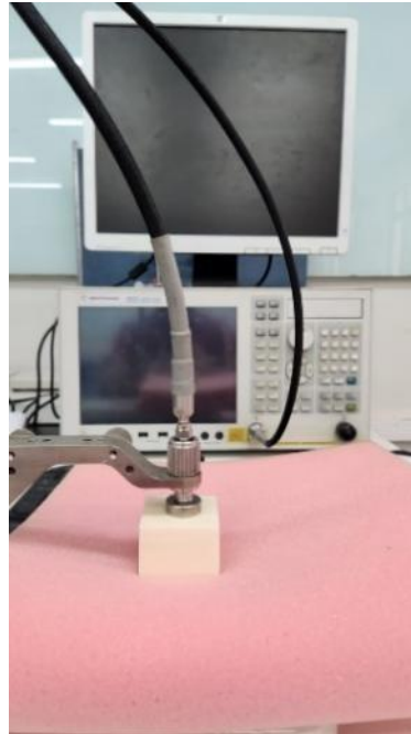
Figura 8 - Setup de caracterização elétrica dos filamentos
