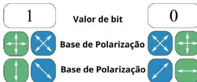
**Figura 2.4:** Esquema de codificação no protocolo BB84. Fonte: Adaptado de *Quantum Cryptography in 5G Network* [Mehic et al. 2024].
