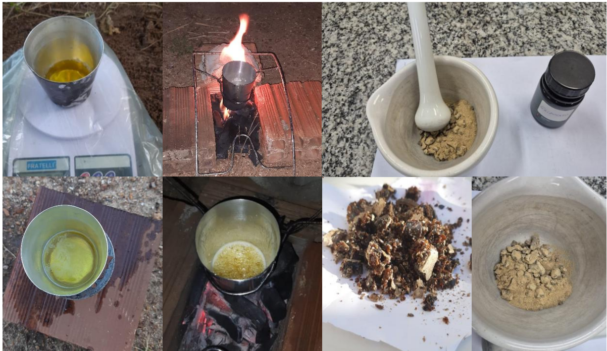
Figura 1– processo para a extração do sal do glifosato
