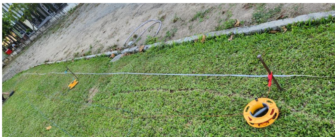
Figura 14: Realização da medição da resistividade do solo
