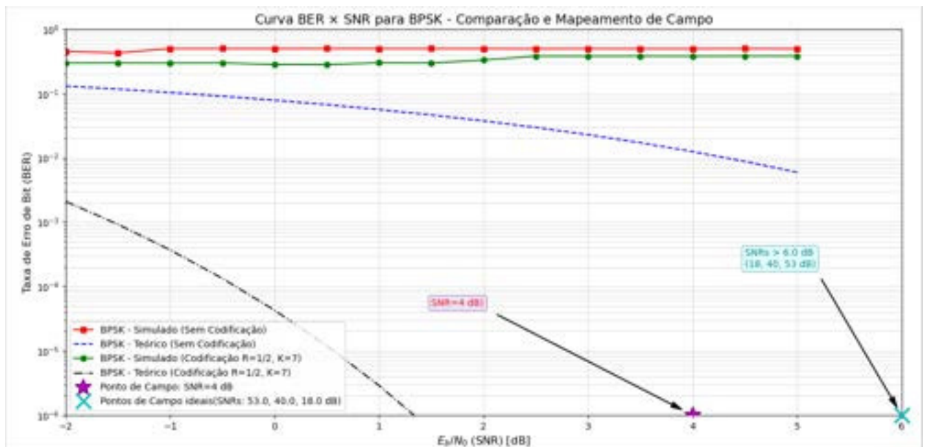
Figura 6.33: Curva BER x SNR Comparação Completa e Mapeamento de Campo.
