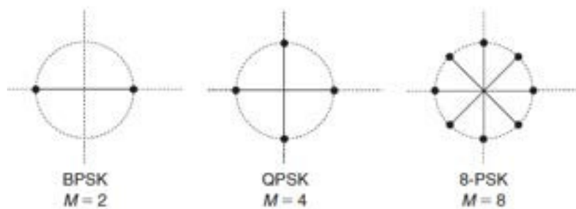
Figura 2.1: Constelações de sinais para BPSK, QPSK e 8-PSK.
