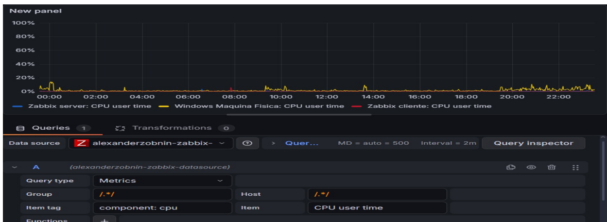
Figura 4.3: Dashboard do Grafana onde mostra o CPU user time das três máquinas.
