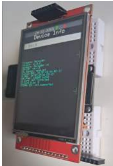
Figura 3.3: Protótipo do módulo ESP32 Marauder montado em breadboard. O autor (2025)
