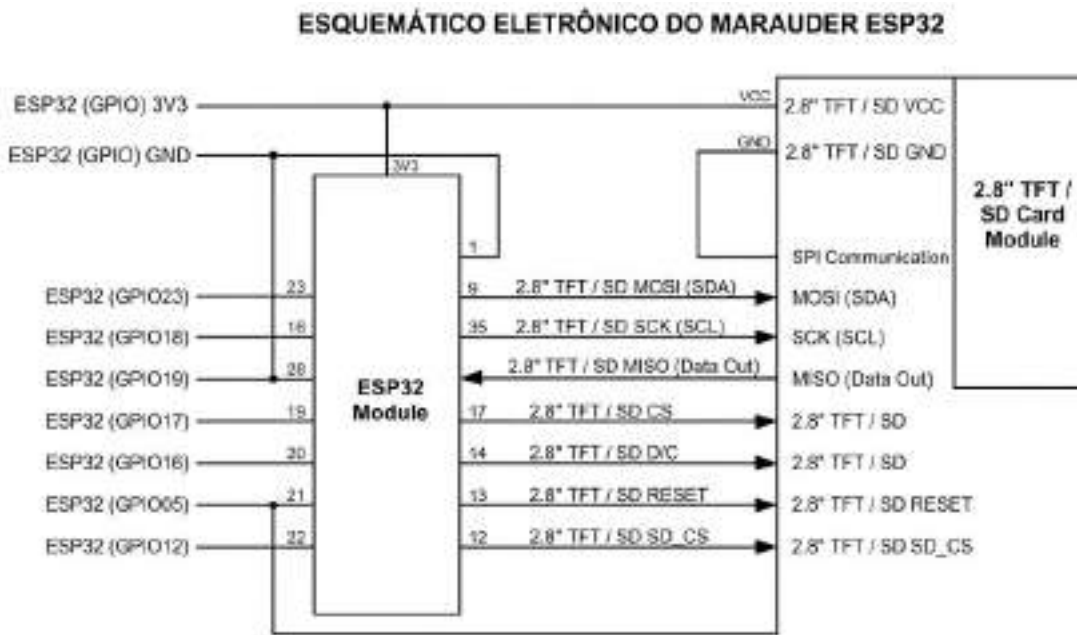
Figura 3.4: Esquemático eletrônico
