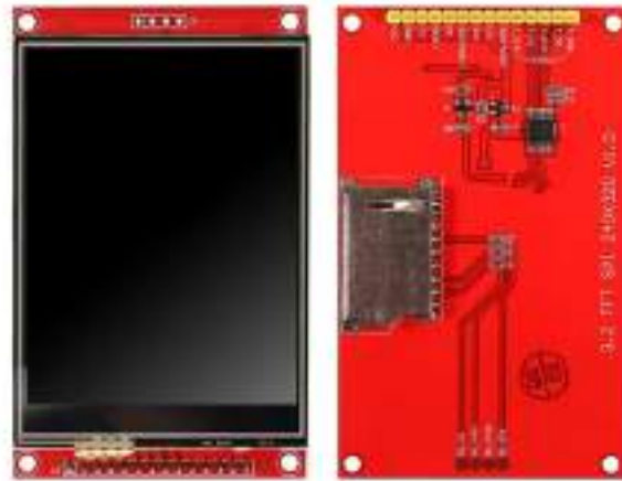
Figura 3.2: Display TFT SPI de 2.8 polegadas com driver ILI9341.
