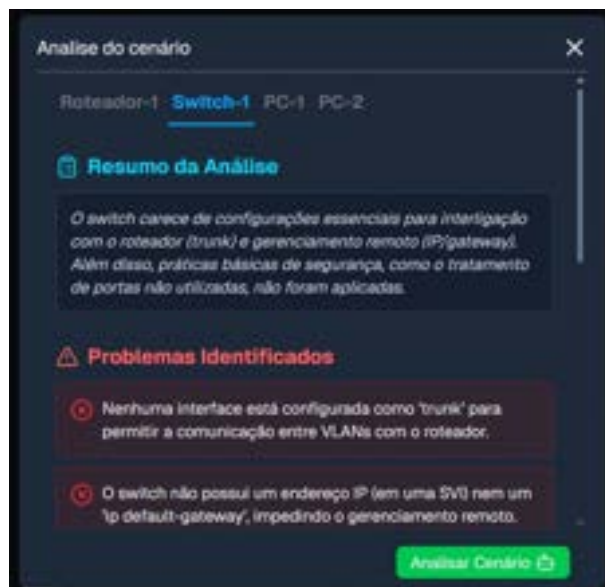
Figura 5.4: Relatório da IA para o Switch-1, identificando a falta de uma porta trunk.
