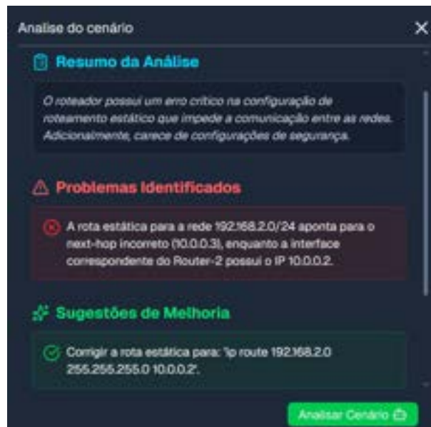
Figura 5.10: Relatório da IA para o Roteador R1, identificando a rota estática com next-hop inalcançável.
