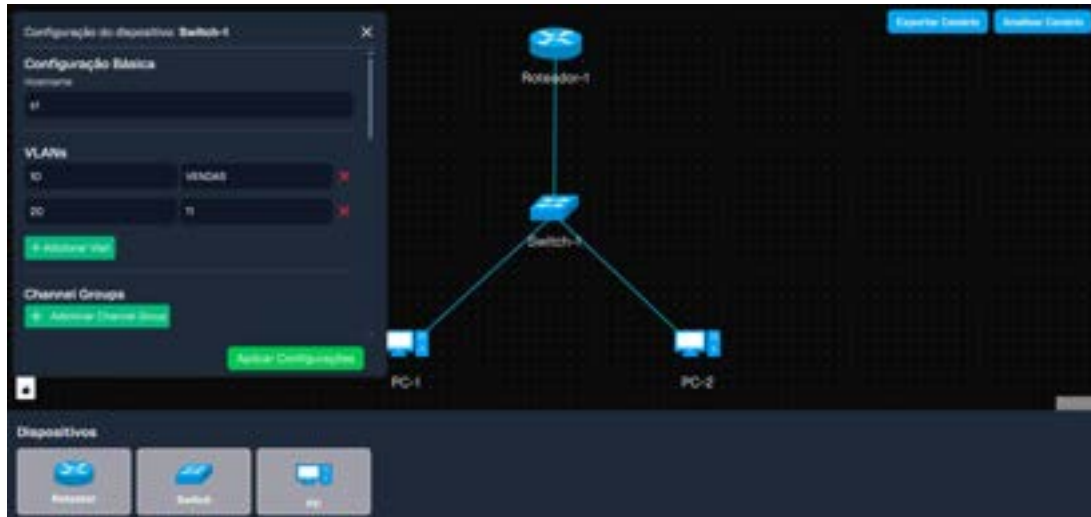
Figura 5.1: Topologia do Cenário A e configuração de VLANs via GUI no Switch-1.
