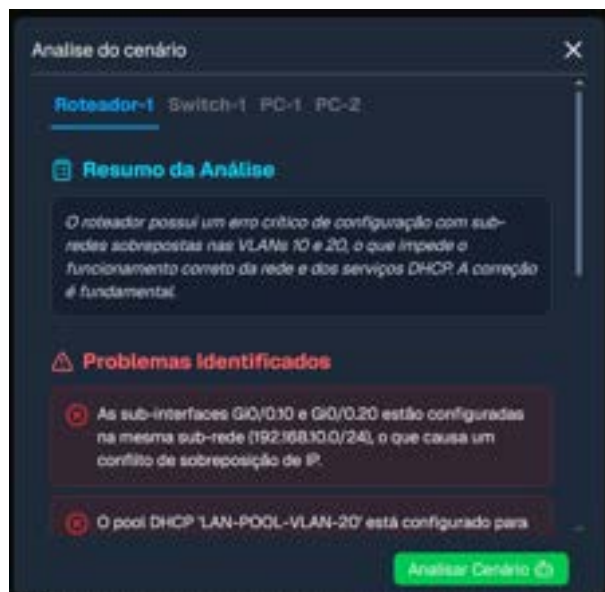
Figura 5.6: Relatório da IA para o Roteador-1, identificando o erro crítico de sobreposição de sub-redes.
