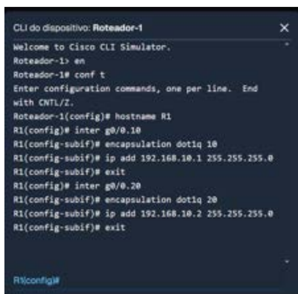
Figura 5.3: Erro proposital (Camada 3): Atribuição de IPs da mesma sub-rede às sub-interfaces do roteador via CLI.
