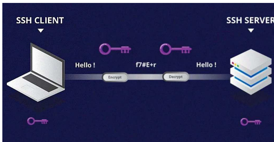
Figura 2.3: Comunicação entre cliente e servidor SSH.
