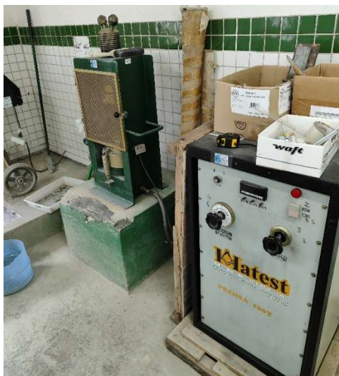
Figura 7 - Prensa hidráulica Matest aparelho usado para medir a resistência a compressão axial
