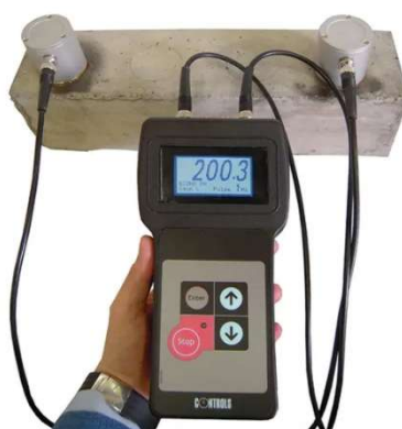
Figura 8 - Equipamento de onda ultrassônica
