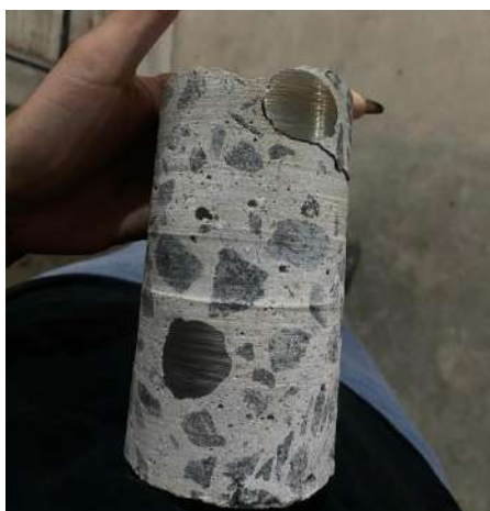
Figura 19 - Seccionamento de armaduras longitudinal
