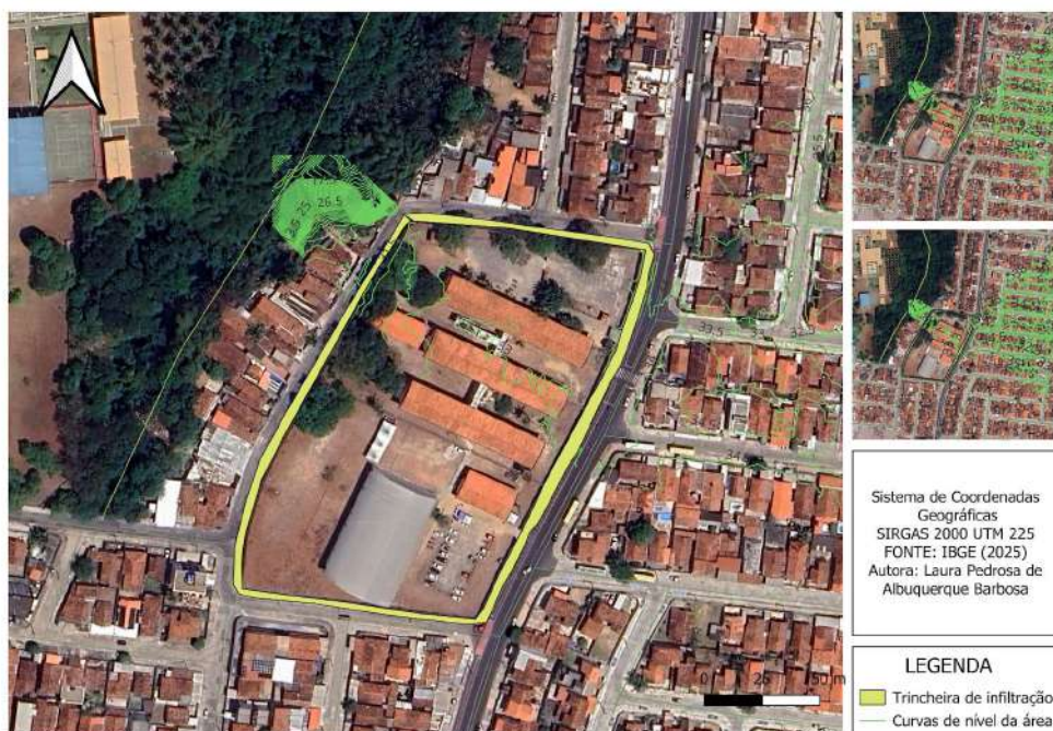
Figura 23 - Solução apresentada com trincheira de infiltração.
