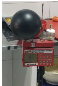
Figura 2: Medidor de Estresse Térmico modelo TGD-400 da marca INSTRUTHERM Fonte: Dados da pesquisa (2023).
