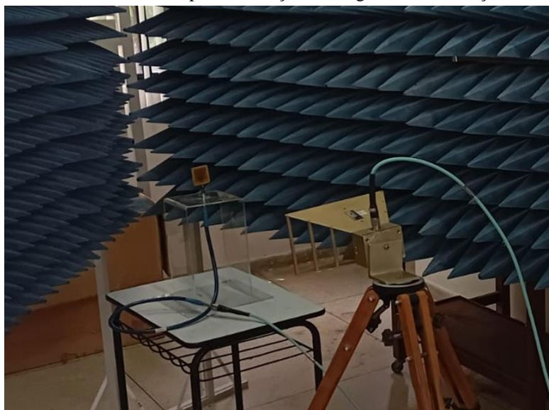
Fig. 41 – Posicionamento das antenas para a medição do diagrama de irradiação em torno do eixo y .
