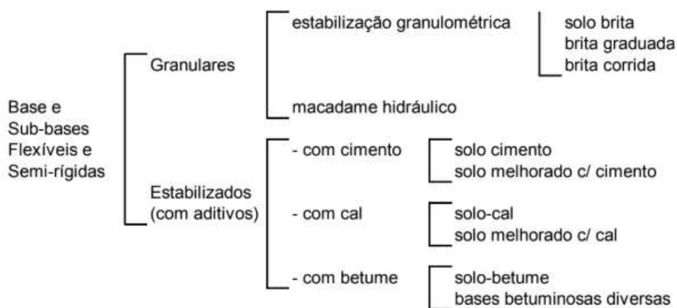
Figura 6 - Tipos de bases e sub-bases flexíveis
