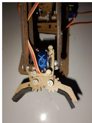
Figura 5 – Detalhes da garra do braço robótico.
