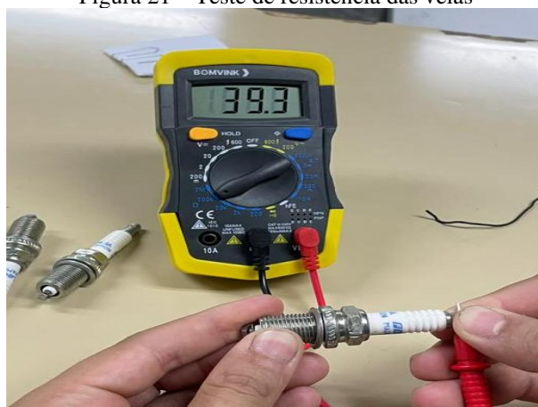
Figura 21 – Teste de resistência das velas
