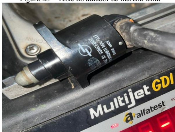
Figura 20 – Teste do atuador de marcha lenta
