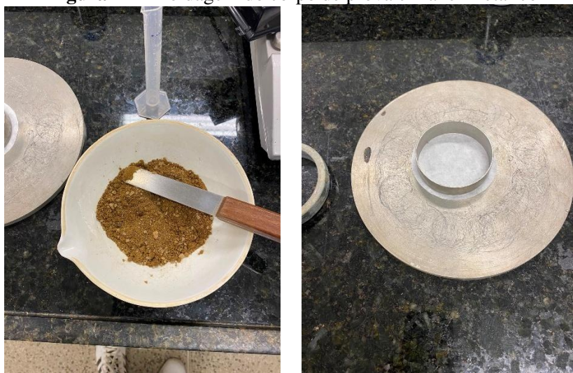
Figura 11 - Moldagem do corpo de prova em anel metálico
