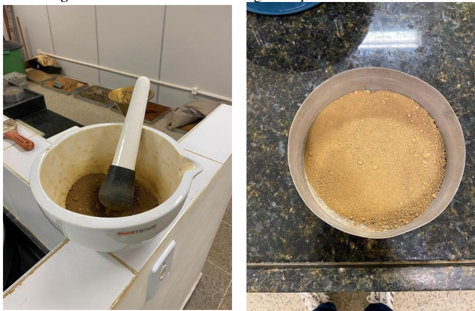
Figura 9 - Destorroamento e homogeneização da amostra de solo.
