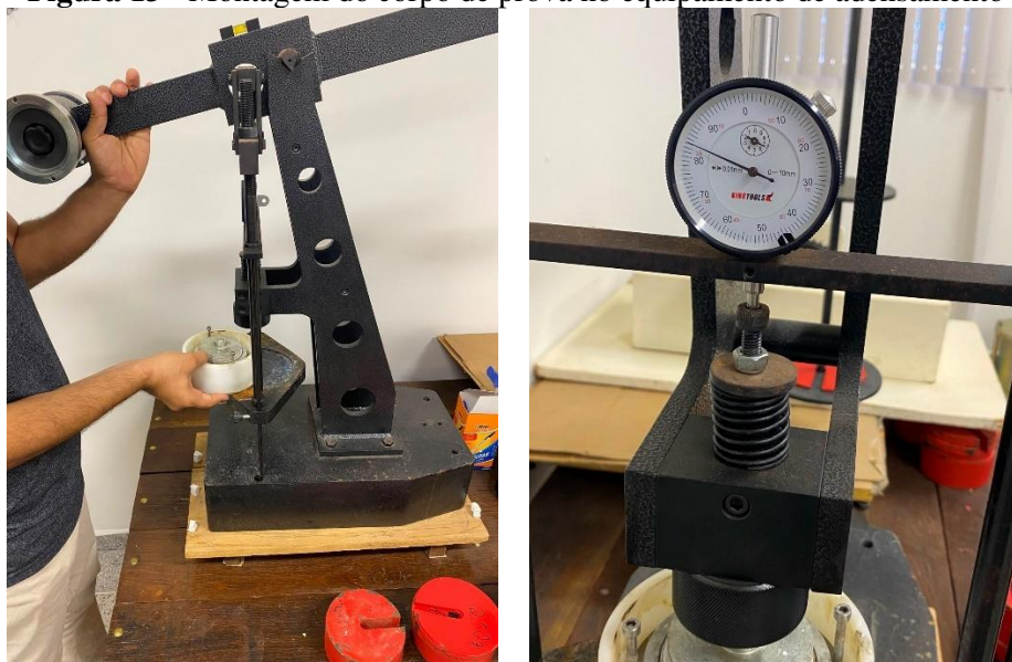
Figura 13 - Montagem do corpo de prova no equipamento de adensamento
