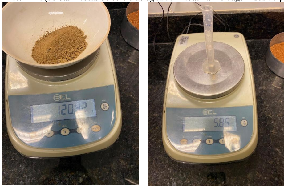
Figura 10 - Determinação das massas de solo e de água utilizadas na moldagem dos corpos de prova.
