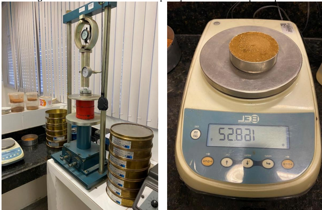
Figura 12 - Prensa utilizada na compactação estática dos corpos de prova.
