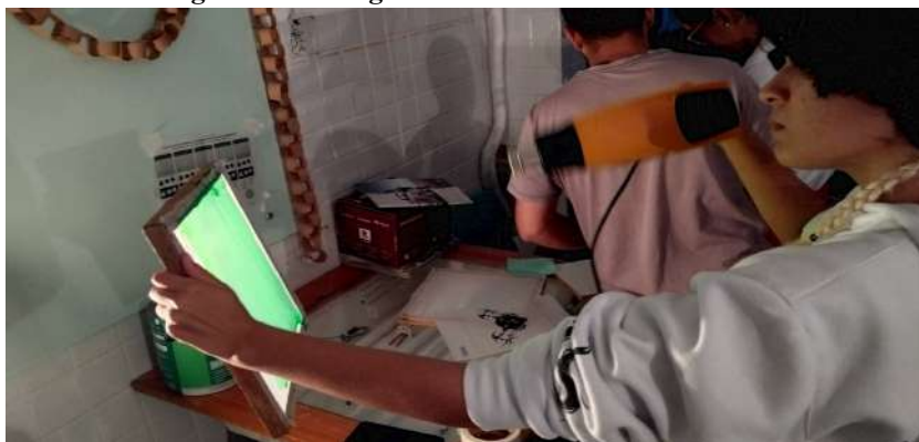
Figura 12 - Secagem da tela emulsionada da tela
