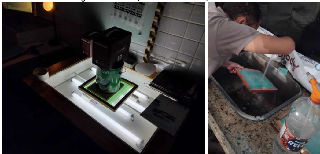
Figura 14 - Gravação da tela e Revelação da tela
