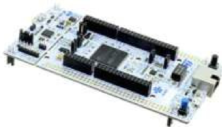
Figura 1 – Placa de desenvolvimento Nucleo-H745ZI-Q.
