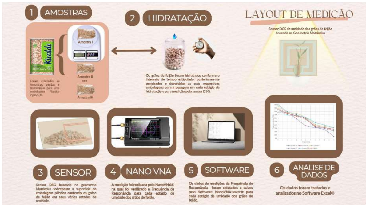
Figura 26 – Layout de medição com sensor de umidade dos grãos de feijão baseado na geometria matrioska
