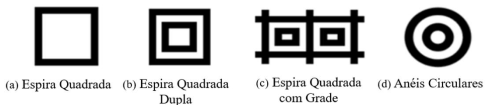
Figura 3 - Elementos do Grupo 2: (a) espira quadrada; (b) espira quadrada dupla; (c) espira quadrada com grade; (d) anéis circulares.
