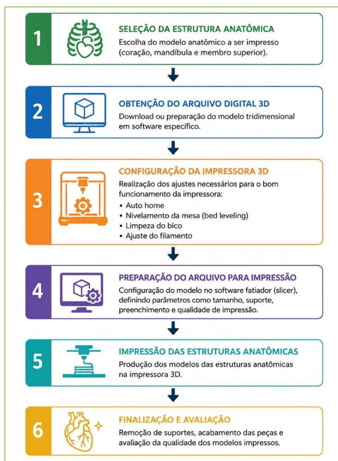
Figura 4 – Fluxograma do processo de impressão 3D das estruturas anatômicas
