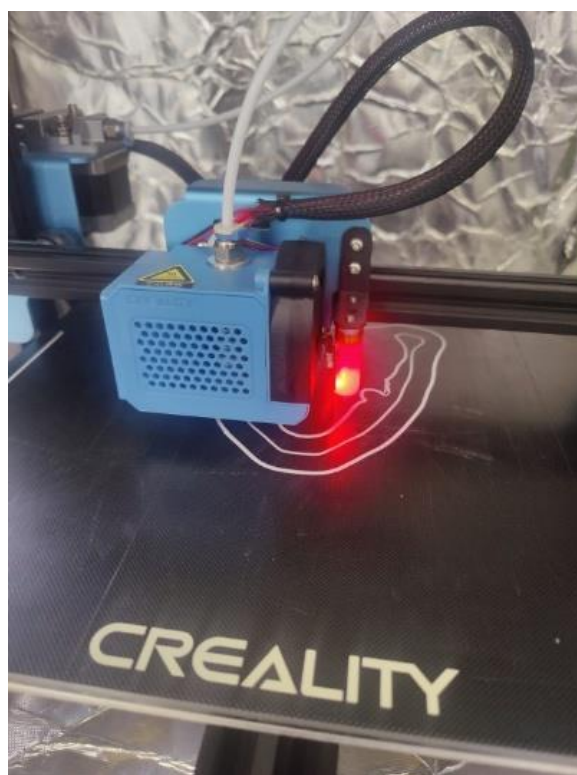
Figura 1 - Impressora 3D em processo de impressão do modelo anatômico da mandíbula utilizado como teste
