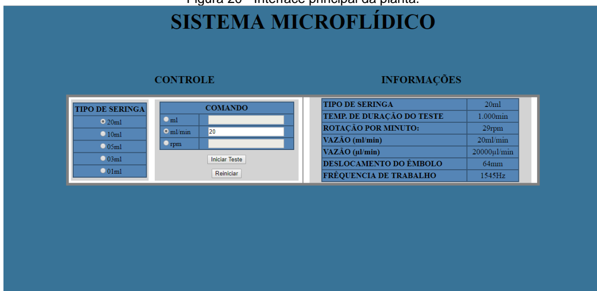
Figura 20 - Interface principal da planta.
