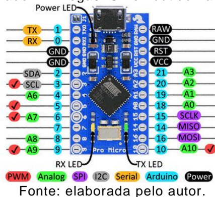
Figura 18 – Microcontrolador ATmega32U4 embutido na placa Arduino Pro Micro.
