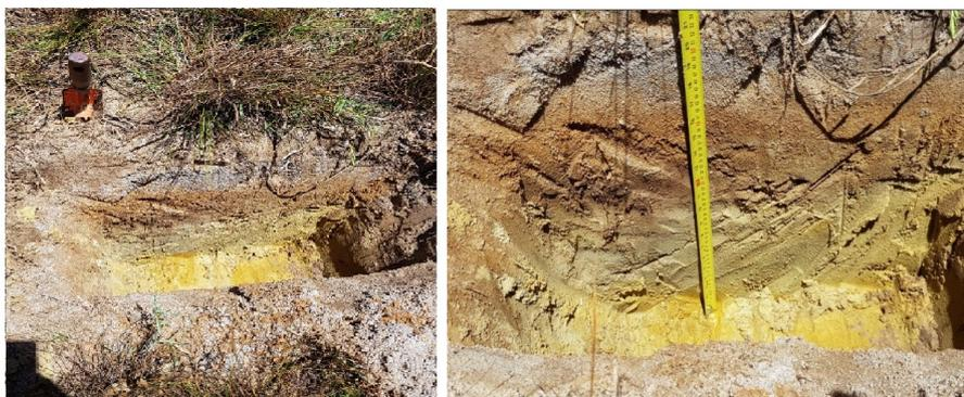
Figura 3.3: Minitrincheira para coleta das amostras do Gleissolo Sáfico. Fonte: Autor.
