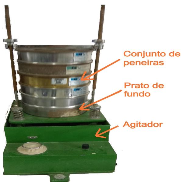
Figura 3.4: Processo de peneiramento do solo. Fonte: Autor.
