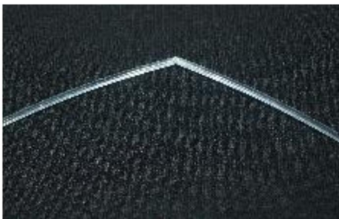
Figura 12 – Fibra de plástico quebradiça depois da remoção da casca utilizando apenas acetona.
