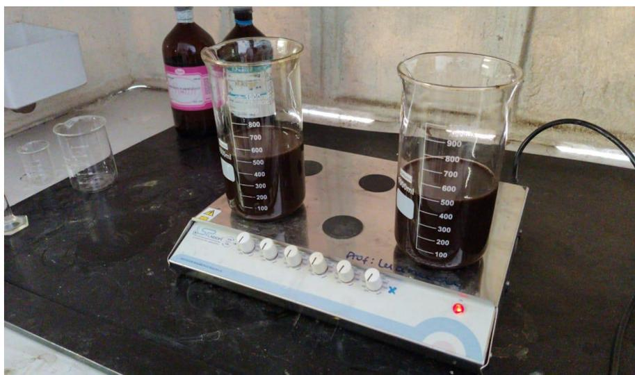
Figura 18 – Solução de 1 litro de água deionizada, com 25 ml de  $\text{H}_2\text{SO}_4$ , 25 ml de peróxido de hidrogênio ( $\text{H}_2\text{O}_2$ ) e o sólido proveniente da centrifugação anterior.
