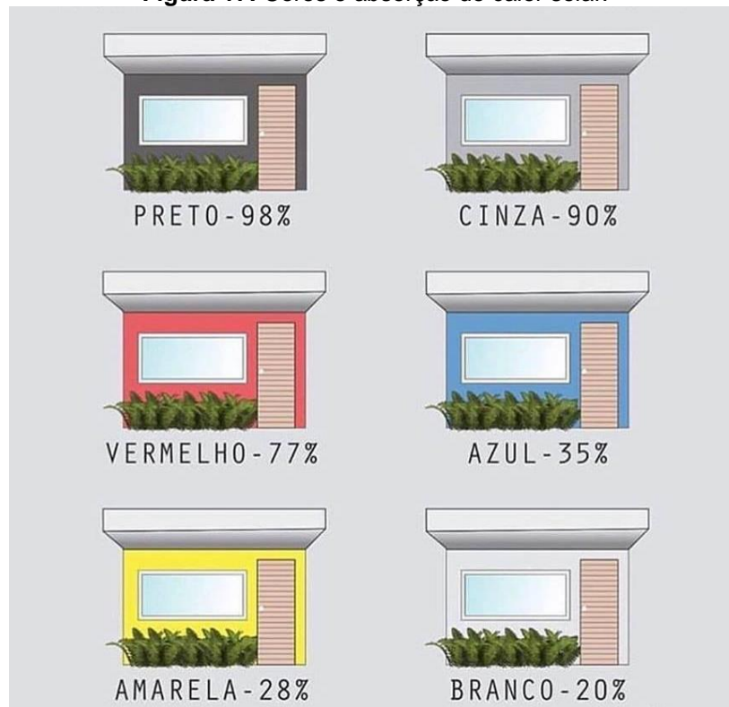
Figura 17: Cores e absorção do calor solar.
