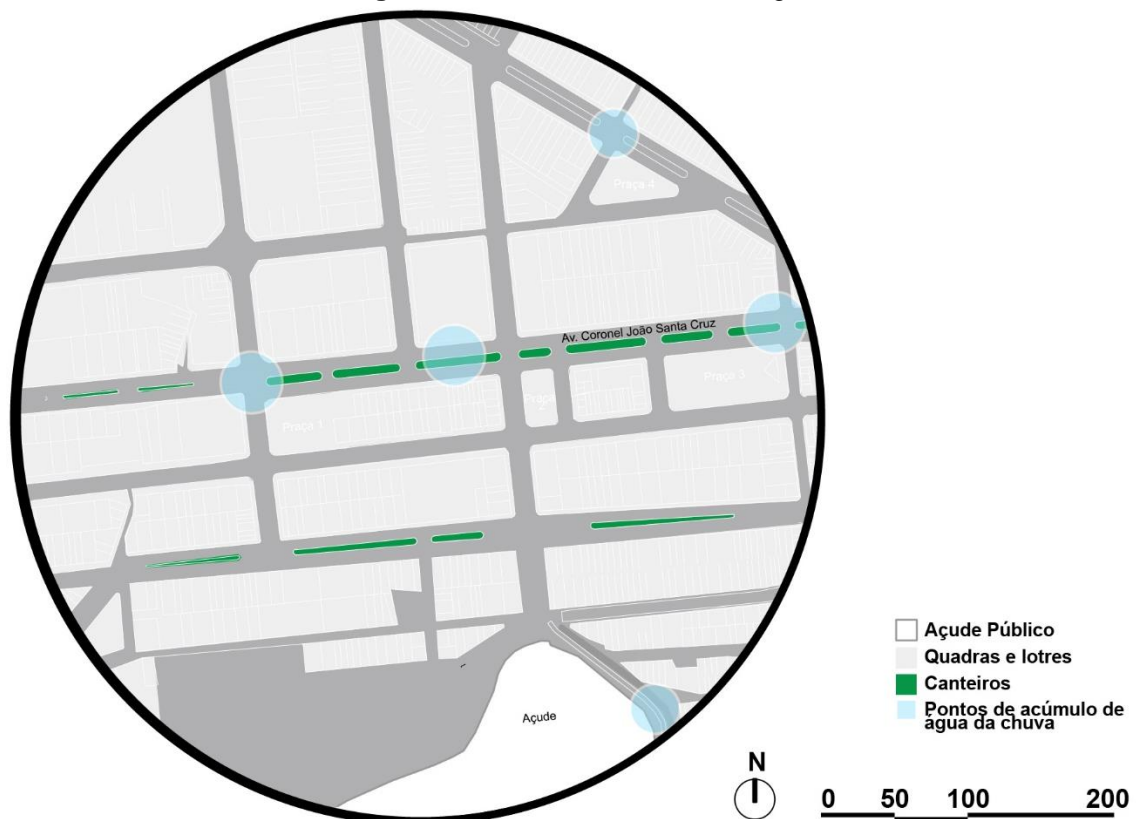
Figura 15: Pontos de acúmulo de água.
