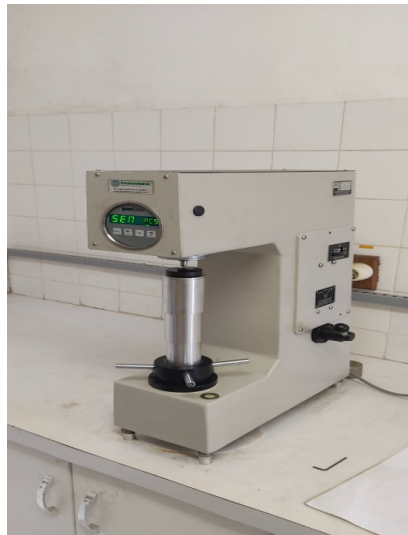
Figura 29 – Durômetro RASN utilizado no ensaio.
