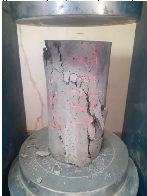
Figura 26 - Corpo de prova rompido à compressão
