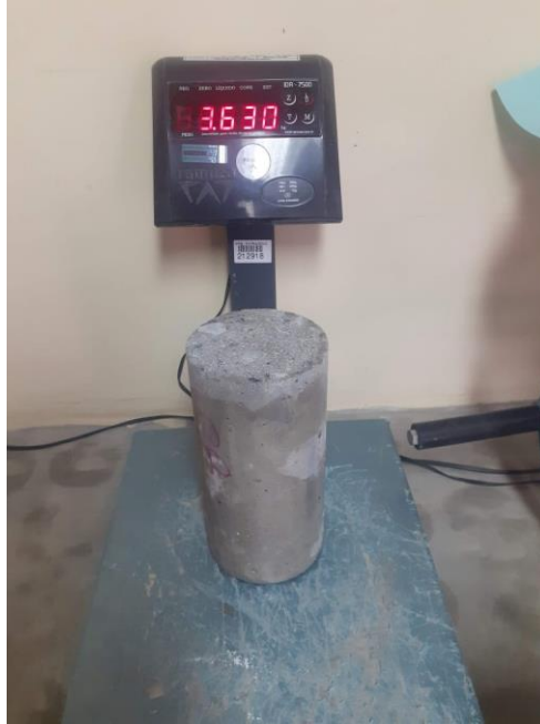
Figura 23 – Verificação da massa do corpo de prova
