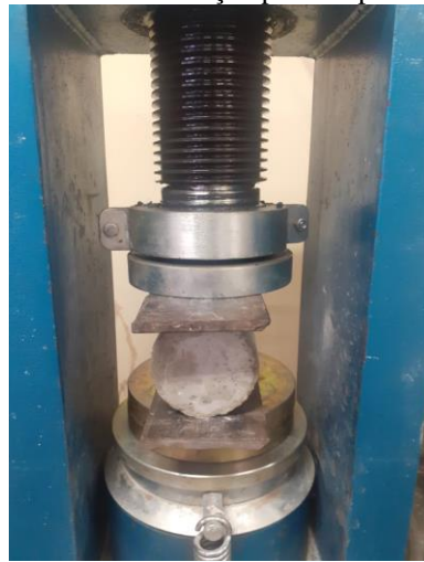
Figura 27 - Ensaio à tração por compressão diametral
