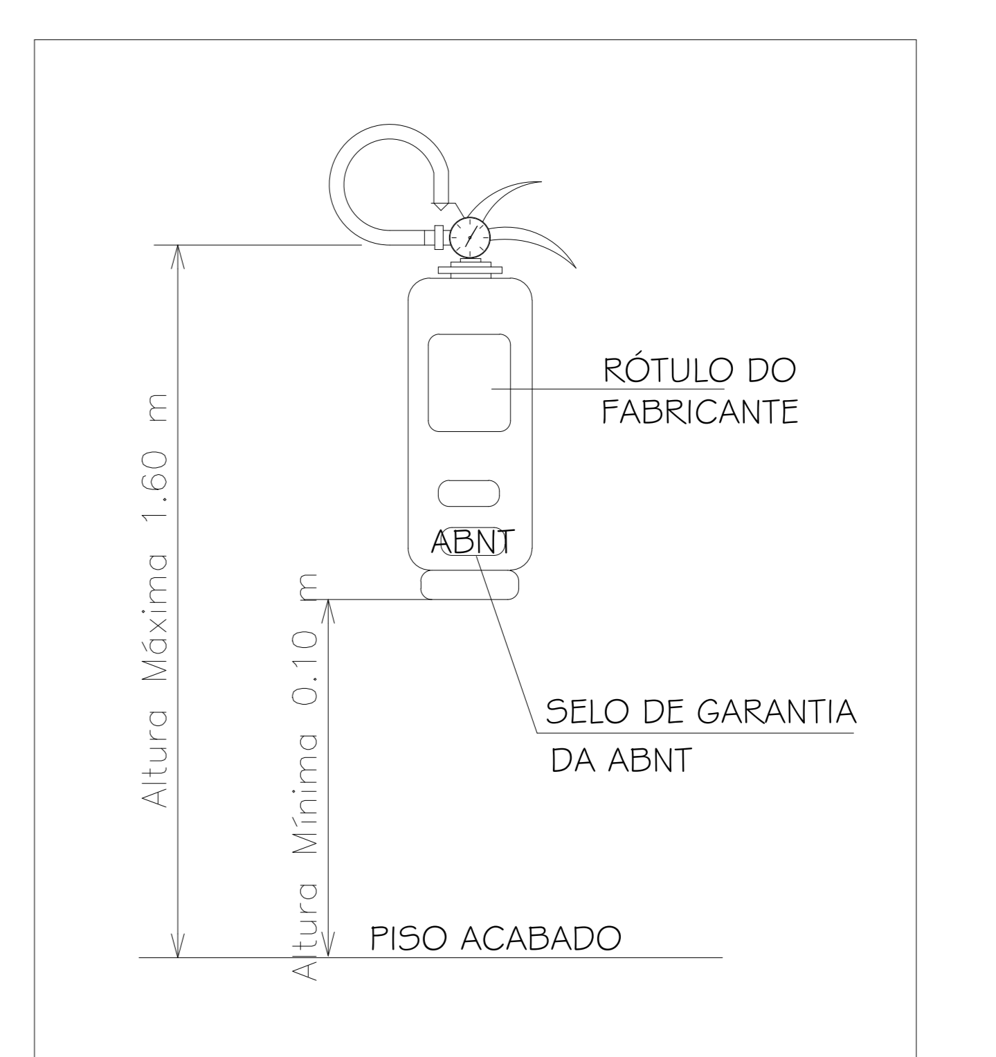
03 DETALHES DE INSTALAÇÃO EXTINTORES SEM ESCALA
