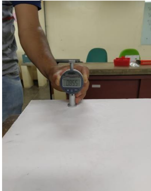
Figura 7 - Ensaio de dureza.
