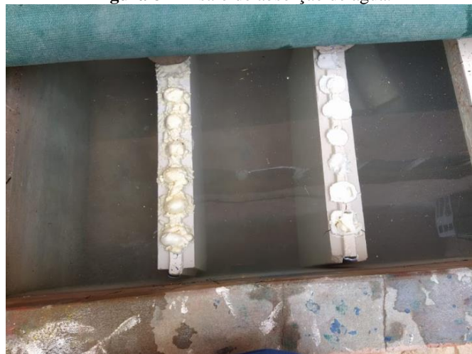
Figura 8 - Ensaio de absorção de água.
