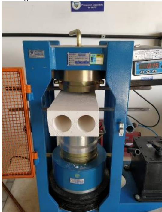
Figura 6 - Ensaio de resistência à flexão.
