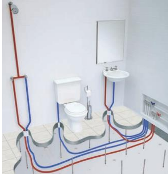
Figura 15 - Instalação por sistema ponto a ponto (Manifold).
