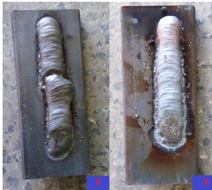
Figura 23: Cordões de solda iniciais (5 e 6)
