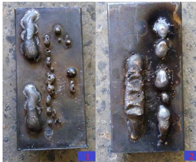
Figura 21: Cordões de solda executados para encontrar ótimos parâmetros de operação (1 e 2)
