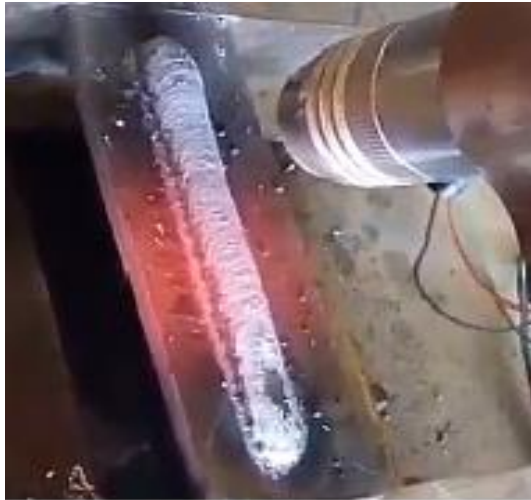
Figura 28: Cordão de solda finalizado
