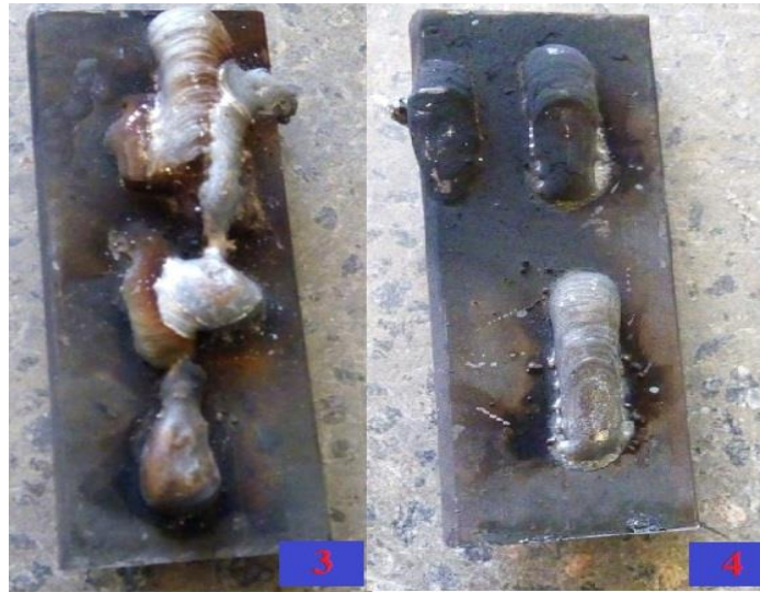
Figura 22: Cordões de solda iniciais realizados à procura de encontrar ótimos parâmetros de operação (3 e 4)
