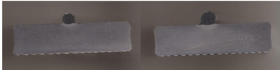
Figura 32: Seção transversal das amostras soldadas na condição sem tecimento.
