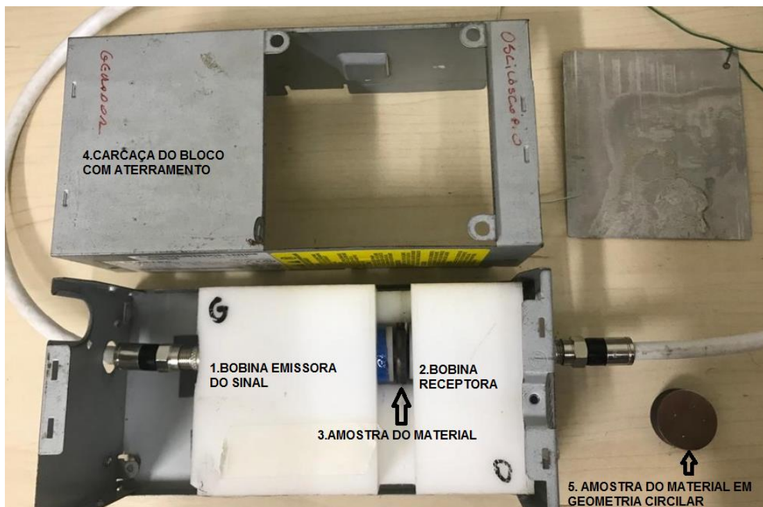
Figura 21. Bloco de emissão e recepção do sinal – detalhe interior. Bobina emissora do sinal (1); bobina receptora do sinal (2); amostra do material (3); carcaça do bloco com aterramento (4); amostra do material em geometria circular (5).
