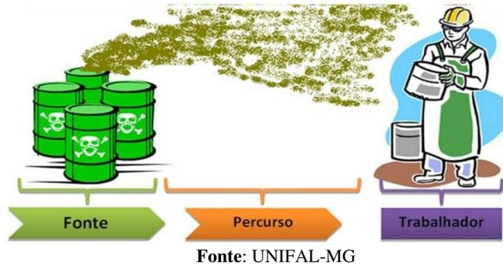
Dando continuidade, para cada uma das fases tem-se as seguintes medidas: Medidas de eliminação, medidas de substituição ou minimização, medidas de engenharia, medidas de separação, medidas administrativas e EPI.
